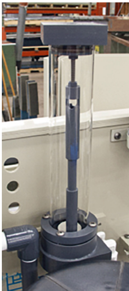
图 1：Chemcut 设备上的立管（透明玻璃管），该立管配有比重控制器（立管中间灰色装置）
