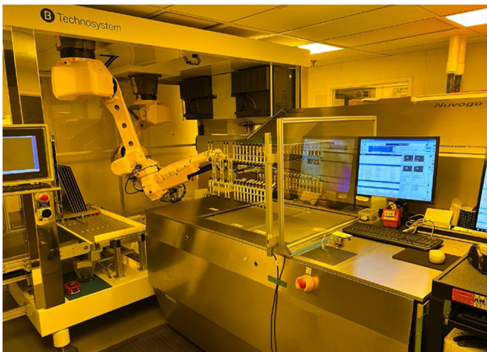
使用 Nuvogo 600 LDI Orbotech 系统进行阻焊成像
