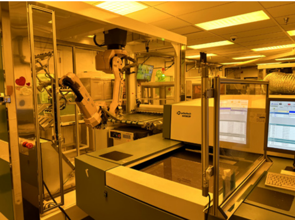
使用 Orbotech Paragon 9800 进行内层及外层成像
