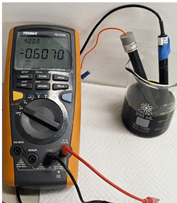
图 2：烧杯测试的基本 ORP 探针设置
