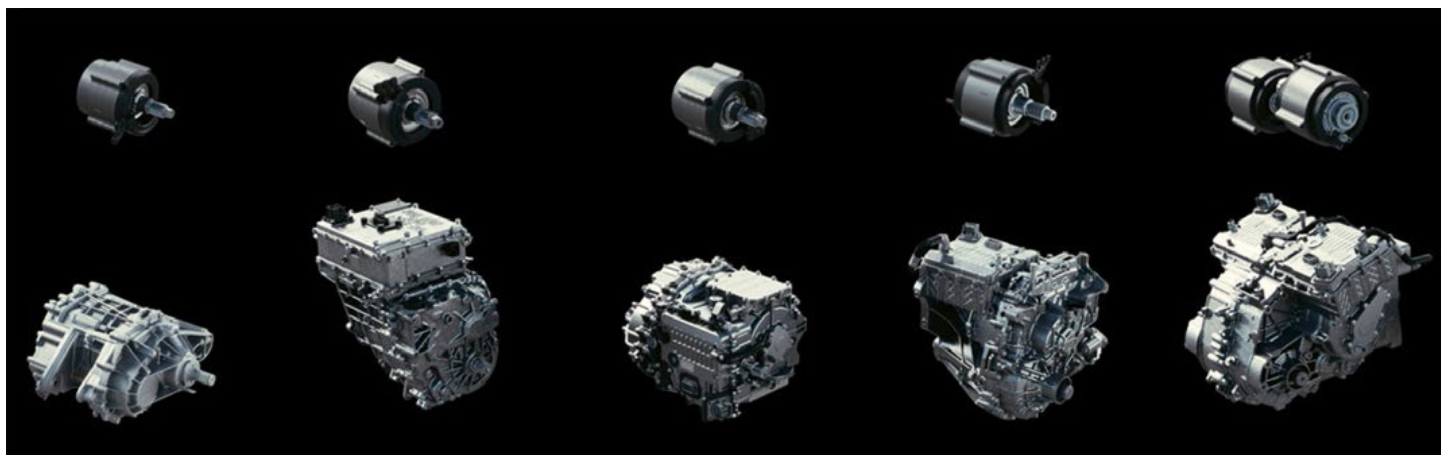
图 7：通用公司的 5 个大双轮电源模块和 5 个小单轮电源装置 [7]
