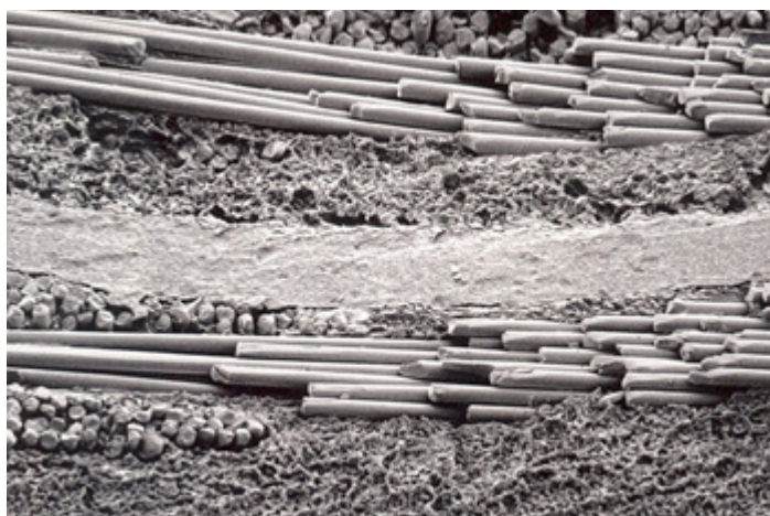
图 3：碱性高锰酸盐去钻污（低 Tg 材料）后的蜂窝结构
